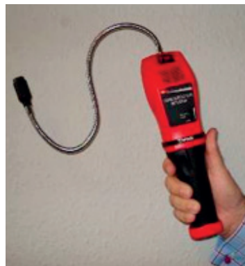
Figure 3 - Rilevatore elettronico di perdite adatto per refrigeranti infiammabili
