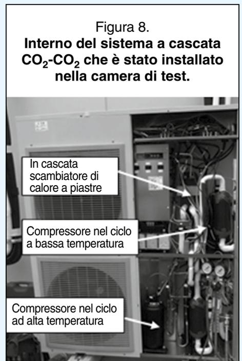
migliore del sistema a cascata CO<sub>2</sub>-CO<sub>2</sub> da circa 15% a 20% e il risultato del test dimostra un rendimento migliore di circa il 15% da parte del sistema a cascata CO<sub>2</sub>-CO<sub>2</sub> rispetto al sistema refrigerante singolo HFC.
