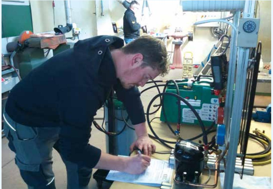
Il candidato Tecnico del Freddo durante l'esame deve sostenere, tra le prove pratiche, un esercizio di rilevamento dati. In questo caso il tecnico sta rilevando il grado di vuoto raggiunto e il tempo di risalita della pressione per valutare la tenuta dell'impianto e eliminare tutte le impurità dell'impianto (incondensabili, umidità etc.).
