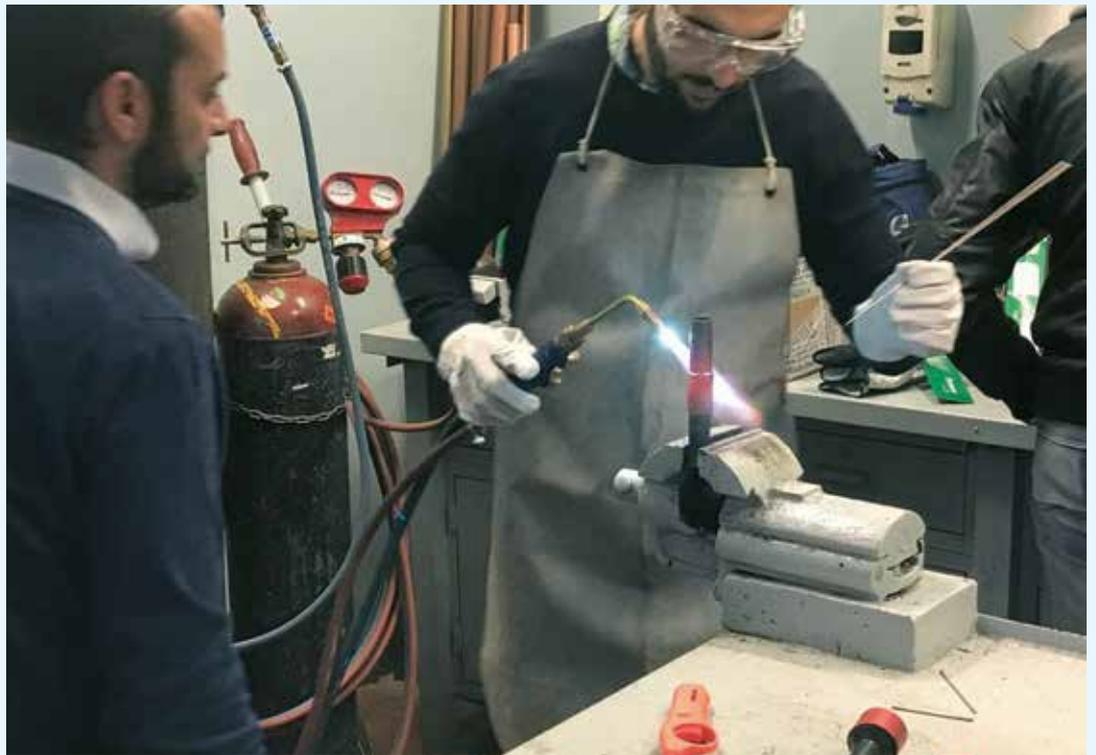
Il docente CSG Vitelli addestra un Tecnico ad eseguire una perfetta brasatura, fondamentale per la tenuta dell'impianto ed evitare che il refrigerante, che potrebbe pure essere infiammabile, fuoriesca nell'ambiente esterno.
