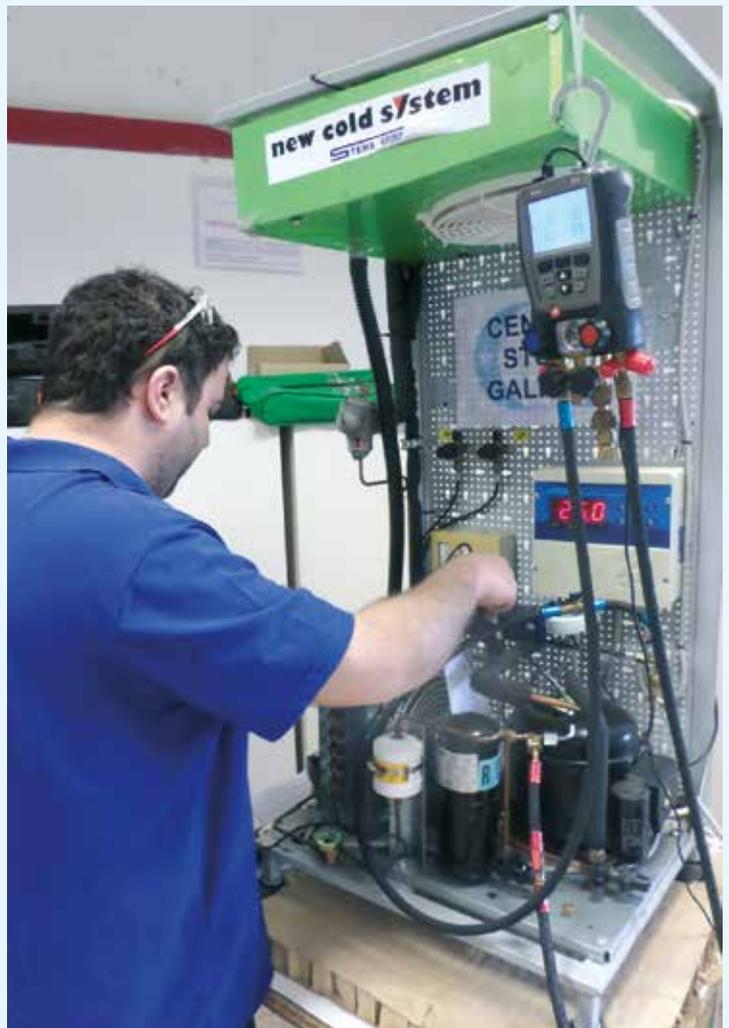
Nella sede di Bologna del Centro Studi Galileo un aspirante Tecnico esegue le rilevazioni, una delle tre prove pratiche per l'ottenimento del Patentino Frigoristi, con strumenti idonei. I refrigeranti infiammabili richiedono strumentazione adatta, in particolare cercafughe e macchina del recupero.
