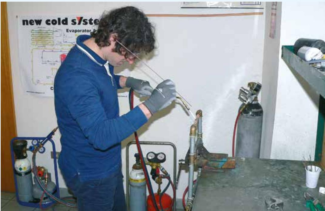
Il Tecnico del Freddo esaminato per l'ottenimento della certificazione di brasatura indossa correttamente le protezioni personali: guanti, occhiali e scarpe antinfortunistiche. Il Patentino Brasatura PED è obbligatorio per saldare impianti in pressione quali quelli di refrigerazione e di condizionamento.
