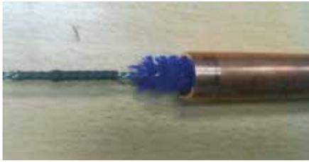
*L'inserto viene inserito all'interno del tubo prima dello strumento di de-sbavatura.*
