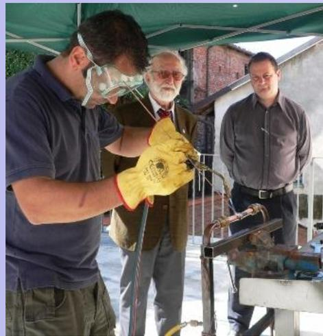
L'operazione di brasatura nell'ambito delle certificazioni per maneggiare i gas refrigeranti
